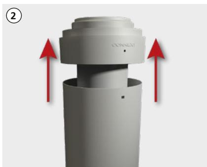
Konzentrische Rohre vor dem Kürzen demontieren. Schlitzschraubendreher unter Kunststoffmuffe in Höhe des Loches ansetzen und leicht anhebeln.
