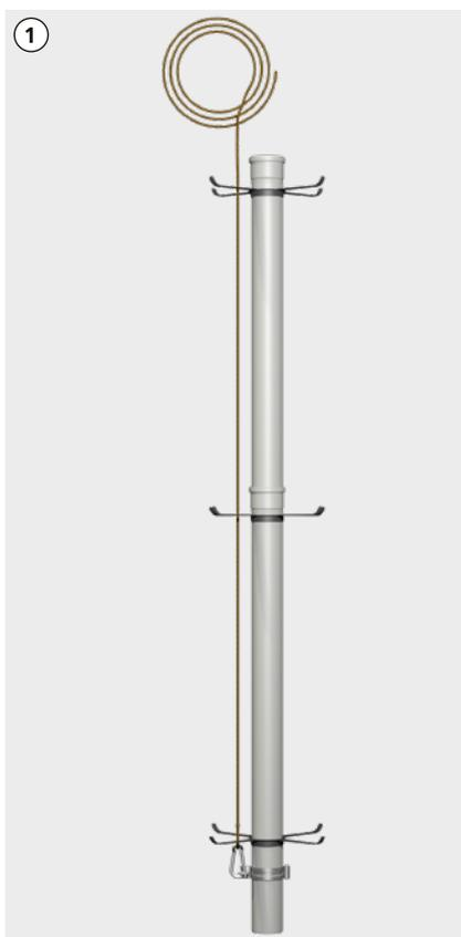
Rohre und Formstücke nach zuvor bestimmter Länge mittels Skoberne Gleitmittel zusammenstecken.
