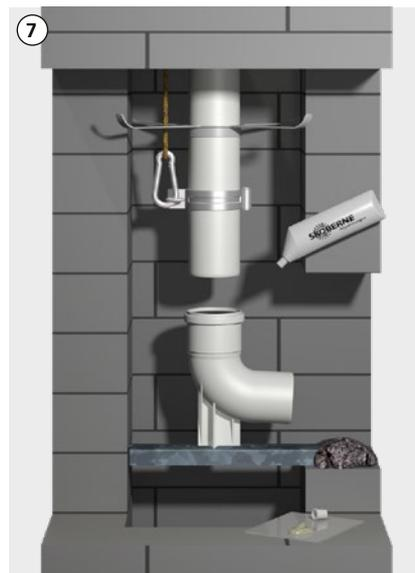
Senkrechte Abgasleitung mit Stützbogen verbinden. Eventuelle Verunreinigungen an der Muffe des Stützbogens entfernen. Skoberne Gleitmittel verwenden.
