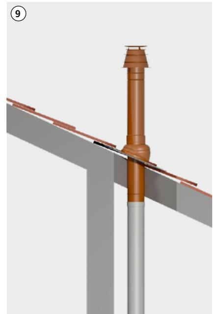
Je nach Dachüberstand ist mit einer Dachdurchführung mit Schrägdachpfanne oder Flachdachkragen zu arbeiten.
