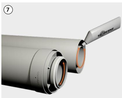
Vor dem Zusammenstecken auf richtigen Sitz aller Bauteile und insbesondere der Dichtungen achten. Steckverbindung mit Skoberne Gleitmittel einstreichen.
