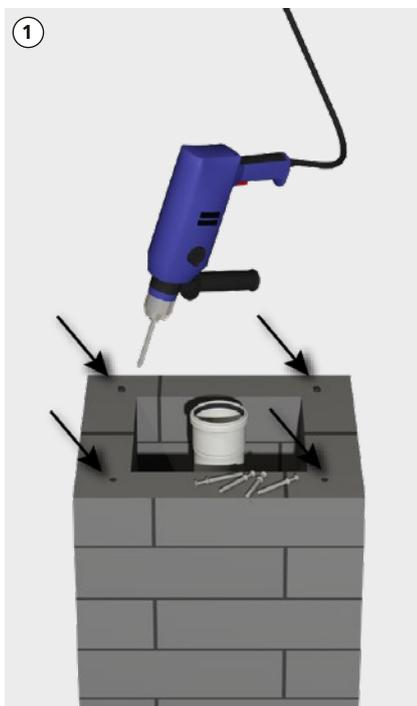
Schachtmündung vorbereiten für Montage der Schachtabdeckung. Vier Befestigungspunkte festlegen und Bohrungen für mitgelieferte Schlagdübel M6 vornehmen.
