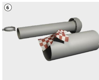
Jeweilige Schnittkanten entgraten und Bauteile vollständig säubern.
