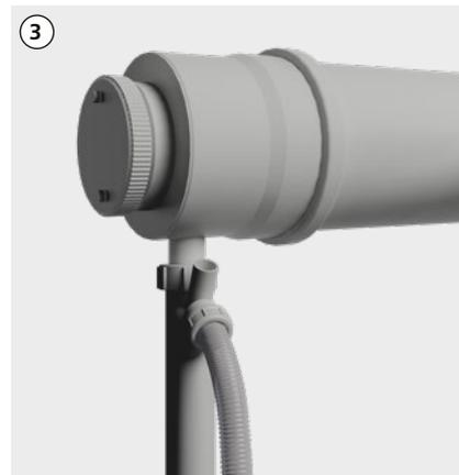
3 Am Ende des Kaskadensammlers den Abschlussdeckel mit Revision und Kondensatablauf positionieren. Siphon mit min. Sperrwasserhöhe von 150 mm installieren. Hinweise zur Kondensateinleitung beachten.
