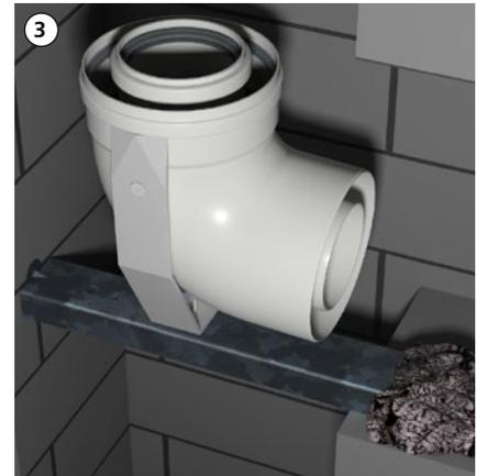
Auflageschiene evtl. kürzen und zusammen mit dem Stützbogen durch die Schachtoffnung in Bohrung einsetzen, ausrichten und fixieren (mit Schraube oder Mörtel).
