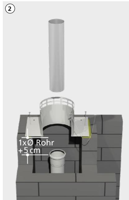
Unterteil der Schachtabdeckung montieren mittels mitgelieferter Schlagdübel. Geeignete Dichtmasse (witterungs- und UV-beständig) zwischen Schacht und Schachtabdeckung verwenden.
