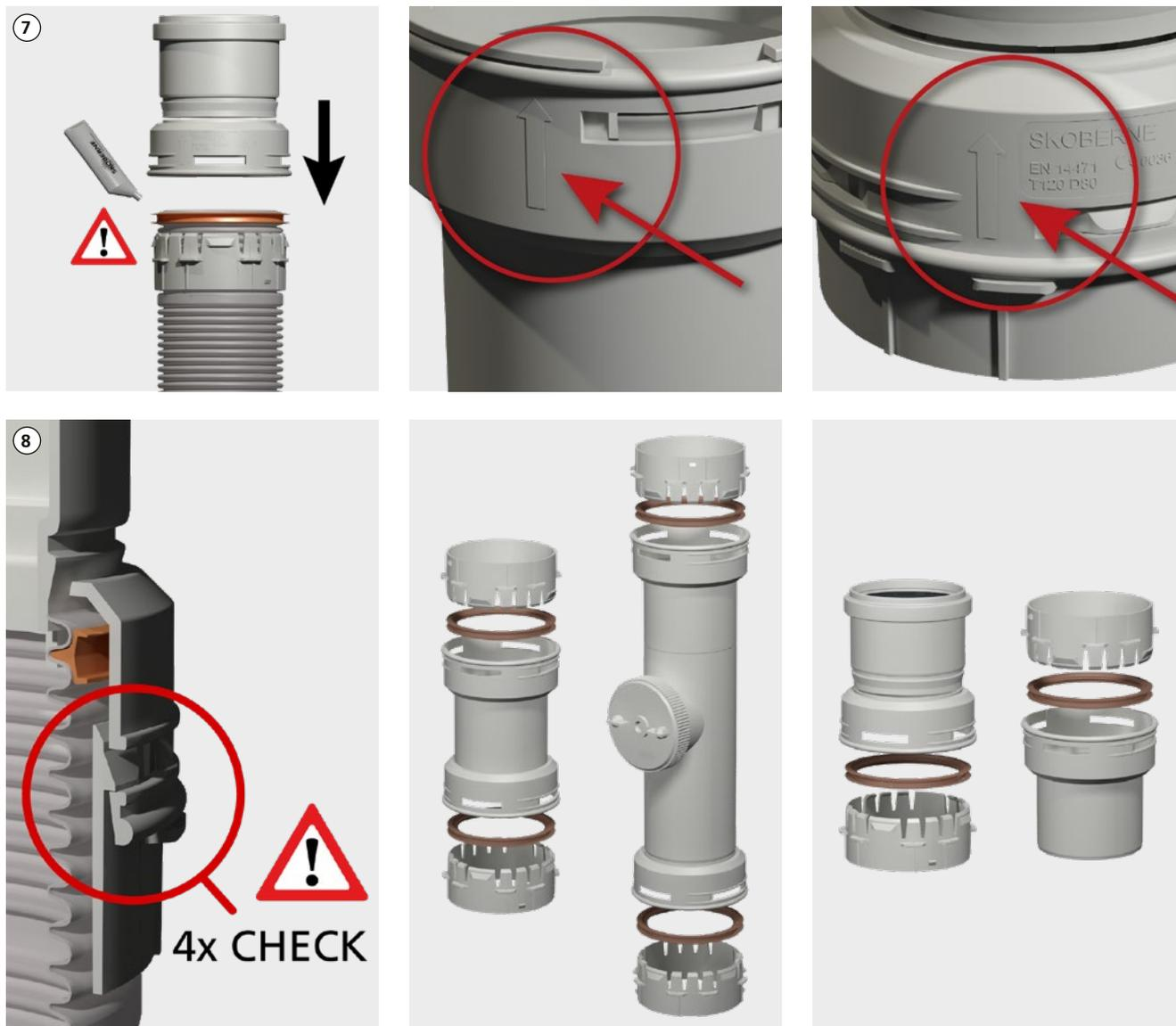
Vor dem Zusammenstecken mit einem Flex-Muffenformteil unbedingt die Dichtung mit Gleitmittel einstreichen. Danach das vormontierte Flexrohr inkl. Montagering einstecken. Sitz der 4 länglichen Rastnasen überprüfen. Öffnen der Verbindung jederzeit durch Drehbewegung möglich.
