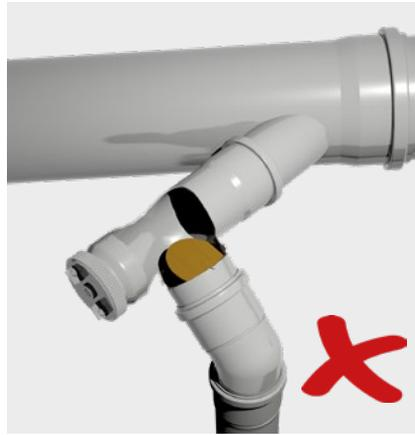
Waagerechte sowie diagonale Einbaulage unzulässig.
