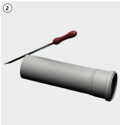
Bauteile winklig schneiden und insbesondere entgraten.
