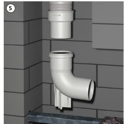
Die Montage der Auflageschiene und des Stützbogens erfolgt bei dem Flexsystem nahezu gleich.
