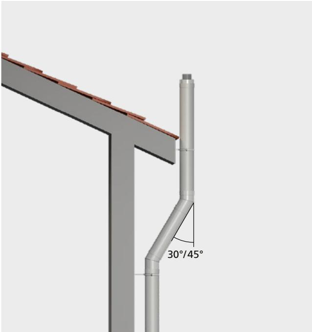
Bei geringem Dachüberstand kann mit Bogenstücken eine Schrägführung eingebaut werden. Mögliche Reinigungsöffnungen sind mit dem/der Bezirksschornsteinfegermeister/in abzustimmen. Bis 15 m senkrechter Leitungslänge und einer Schrägführung bis 30° reicht hier die untere Revisionsöffnung zur Überprüfung der Abgasleitung (Quelle: DIN 18160 Abschnitt 6.5.3).
