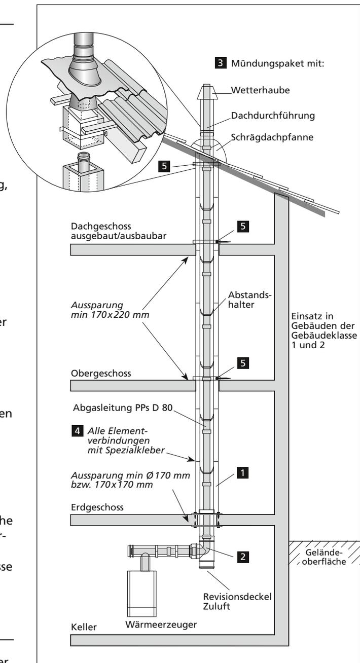
SKOBIFIXS® 30 – System-Leichtbauschacht L<sub>A</sub>30 inkl. Abgasleitung D 80 für Brennwerttechnik, Außenmaß 150 x 200 mm, zum Einsatz in Einfamilienhäusern
