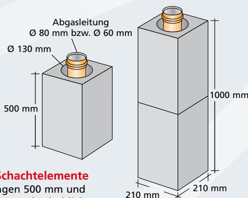
**Die PORIFIX Schachtelemente** sind in den Längen 500 mm und 1000 mm (2x 500 mm) erhältlich und werden inklusive Polypropylen-Abgasleitung und Abstandhalter geliefert.
