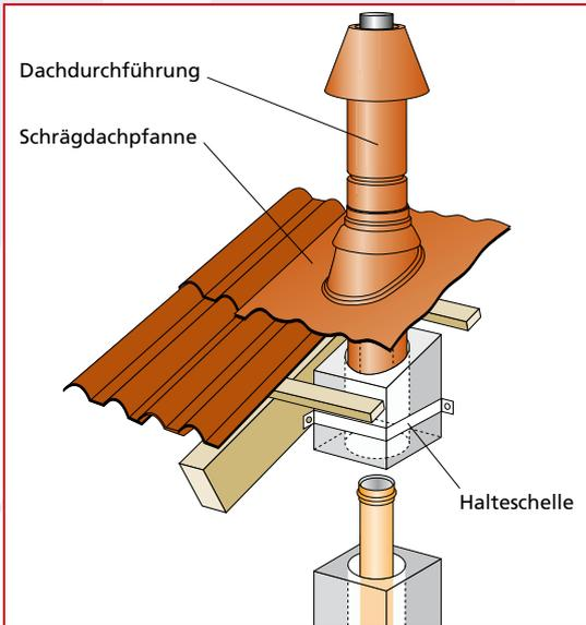
Die Dachdurchführung ist in zwei Längen und zwei Farben lieferbar. Die Schrägdachpfanne lässt sich im Neigungswinkel einstellen. So bietet **PORIFIX** die individuelle Lösung für fast jedes Dach.
