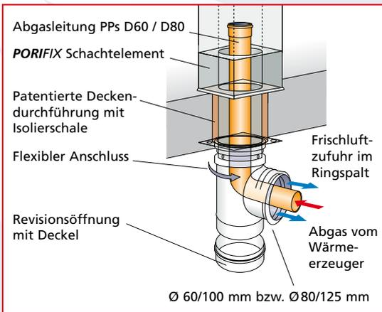
Das patentierte Deckenanschlusselement ermöglicht die Überprüfung von Zuluftringspalt und Abgasleitung. Ganz einfach vom Aufstellraum aus. Zusätzliche Einrichtungen wie ein Dachausstieg sind nicht mehr erforderlich.
