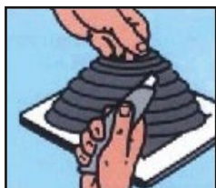
1. Dektite® an Rohr anpassen
