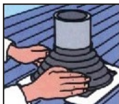
3. Dektite® formgenau an Profilblech anpassen
