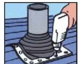
5. Dektite® mit JT 3 Edelstahl-Bohrschrauben oder Bulbitie-Nieten befestigen. Zusätzliche Sicherung durch Rohrschelle möglich.
