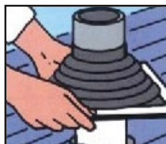
2. Dektite® an Profilblech anpassen und markieren
