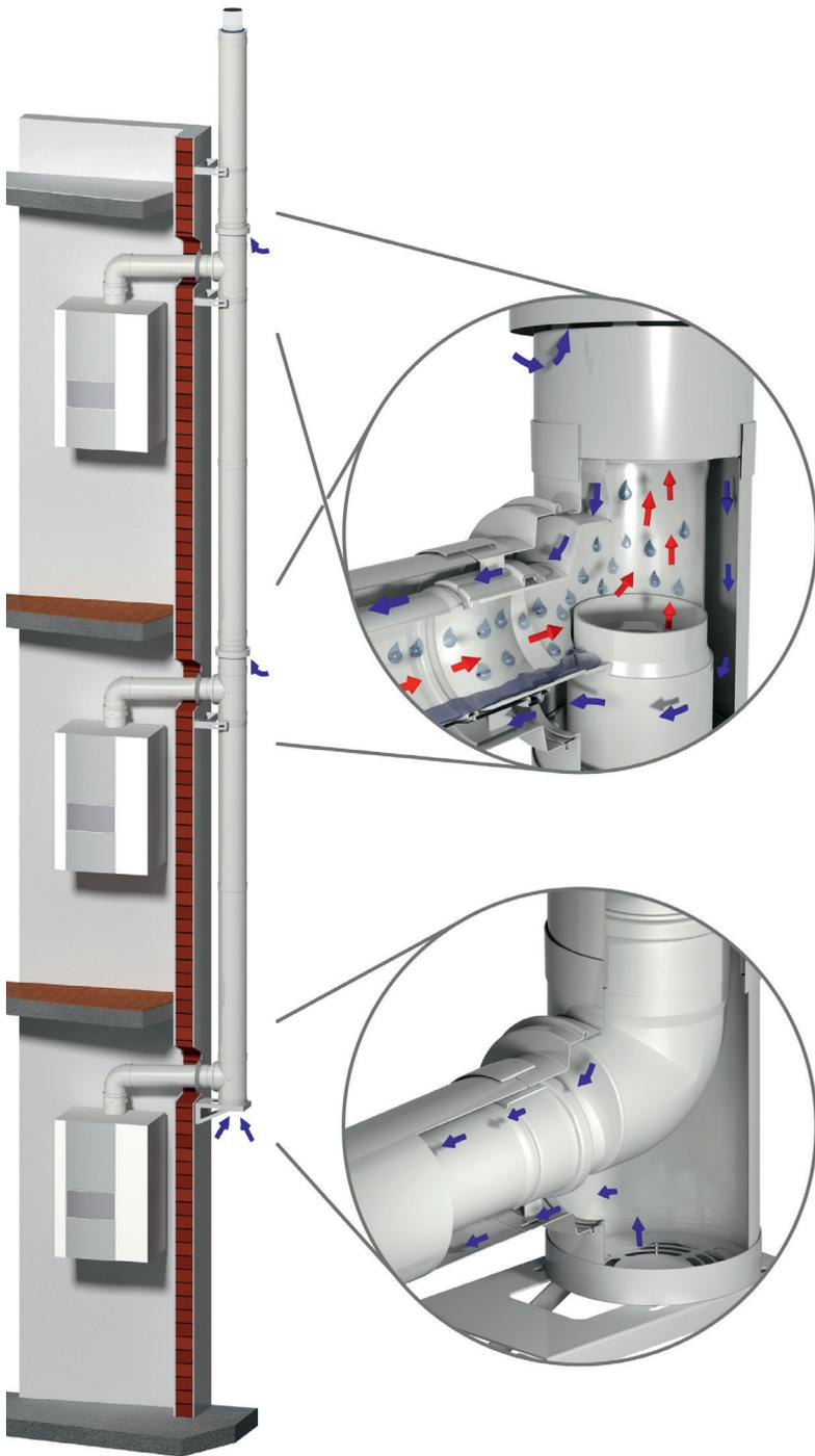
Die „MFB-Außenwand“ ermöglicht es, in Mehrfamilienhäusern mit mehreren konventionellen Heizgeräten schrittweise auf die Brennwerttechnik umzustellen. Die Herausforderung dabei: konventionelle Heizgeräte können nicht zusammen mit Brennwertgeräten an einem Abgasstrang im Überdruck betrieben werden.
